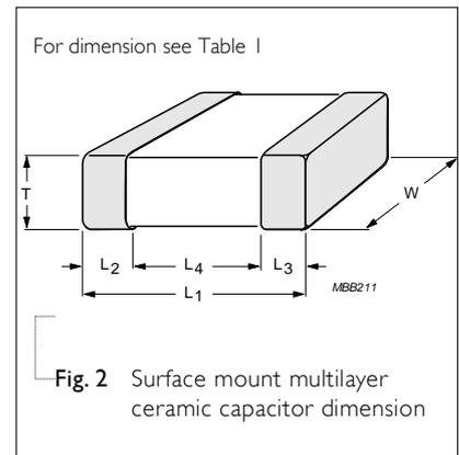
**CAPACITANCE RANGE & THICKNESS FOR X6S**
