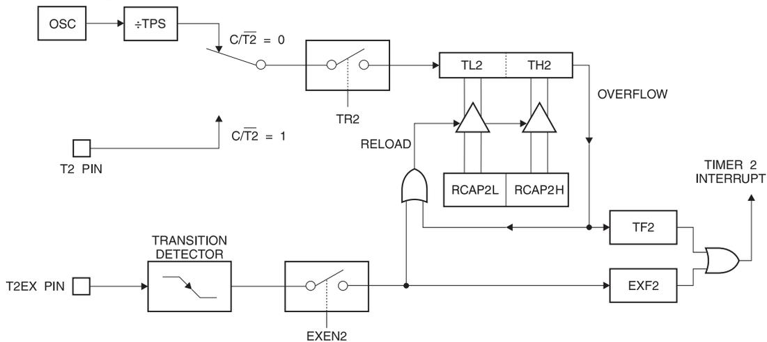
**Figure 12-3.** Timer 2 Waveform: Auto-Reload Mode (DCEN = 0)
