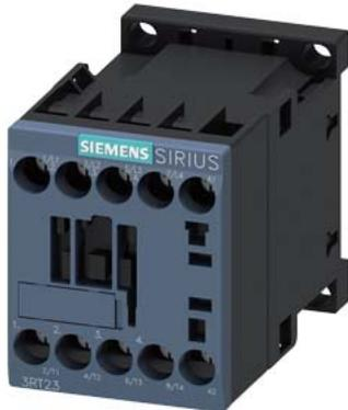
Schütz AC-1, 18 A, 400 V / 40 °C, 4-polig, AC 220 V, 50 Hz / 240 V, 60 Hz, Schraubanschluss, Baugröße: S00
