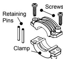
**Flexible Conduit Clamp & Hardware Pak**
